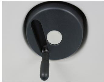
Molette de réglage pour l'ajustement du taillage latéral du margeur, de la perforation et de la réception
