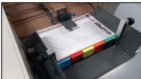
Margeur ajustable grâce à des butées magnétiques et glissantes
