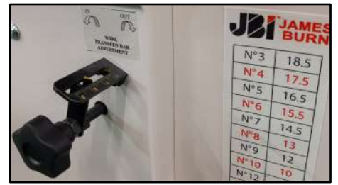
Le réglage de la profondeur de la barre magnétique de transfert du Wire-O® se fait très simplement
