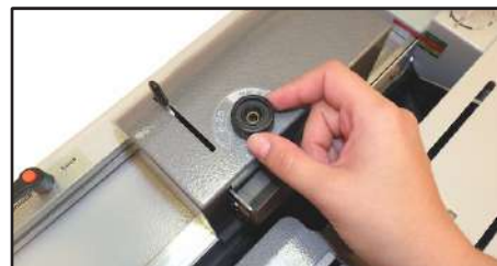
Bouton de réglage pour élargir ou rétrécir la sertisseuse en fonction de la taille de la bobine sélectionnée
