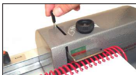
Levier pour ajuster le dispositif de maintien de la spirale en fonction de sa taille et des indications indiquées sur la bande colorée
