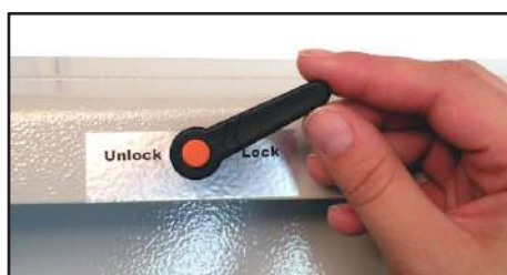
Sécurité pour verrouiller ou déverrouiller les réglages de la sertisseuse
