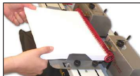
Sécurité pour les deux mains de l'opérateur qui doit maintenir le document pendant le cycle de fonctionnement
