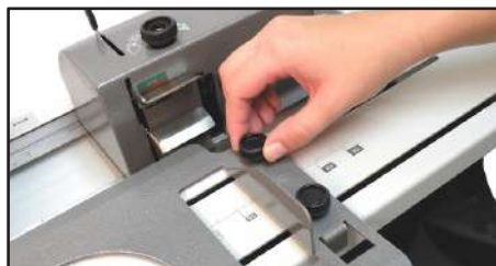
Présence de repères pour adapter les butées à la bonne longueur des documents à sertir
