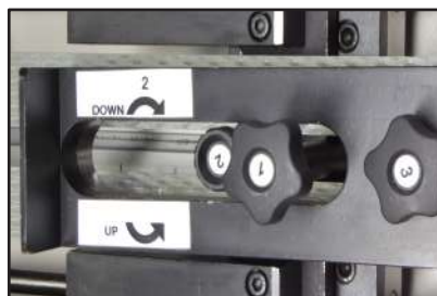
Mise au format facile de la butée arrière avec le réglage du bloc poussoir
