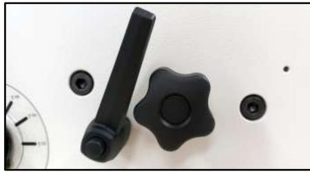
Réglage possible du parallélisme de la presse pour une fermeture homogène de la reliure Wire-O®
