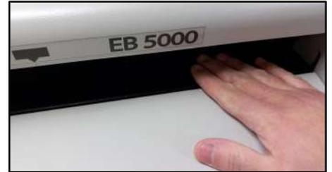
Sécurité renforcée grâce à une protection anti-pincement avec dégageage automatique de la presse
