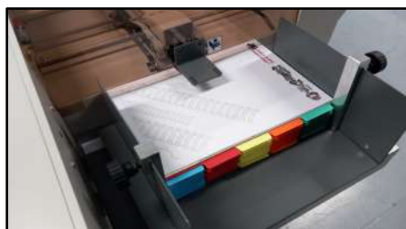
Margeur ajustable grâce à des butées magnétiques et glissantes
