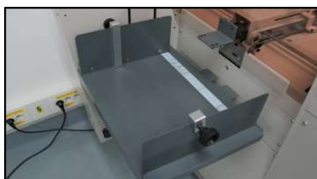
Margeur avec une capacité de 100 mm (2 ramettes ~ 1,000 feuilles)
