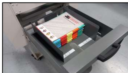
Réception escamotable permettant une prise aisée des feuilles perforées
