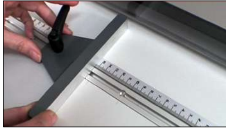
Présence d'une butée latérale de travail facilement et rapidement réglable
