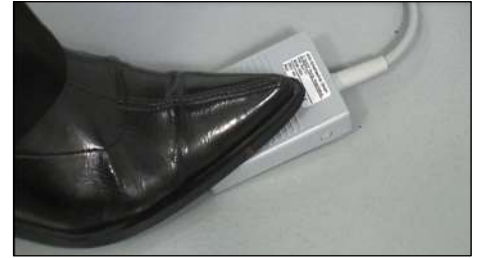
Opération de perforation déclenchée via une pédale pneumatique
