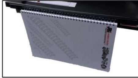
Dispositif de crochets facilitant l'insertion des feuilles perforées dans la reliure Wire-O®
