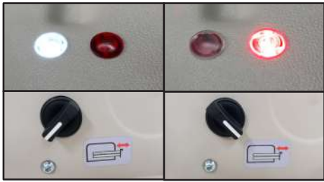
Indicateurs LED pour signaler le bon positionnement de la machine lors d'un changement d'outil
