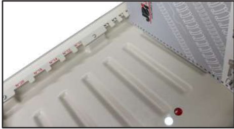
Présence de jauges pour définir le bon diamètre de reliure Wire-O® en fonction de l'épaisseur du document à relier
